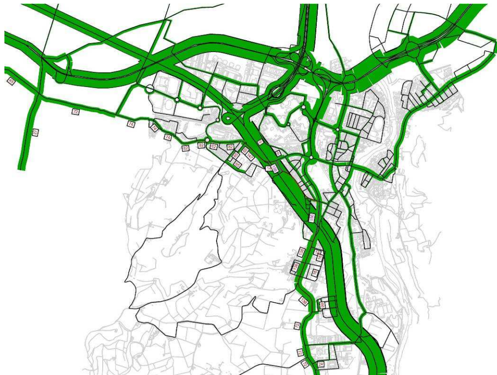
Figura 30. Composizione di flusso - itinerario: Via Bazzanese-Via Calzavecchio-Via Porrettana
